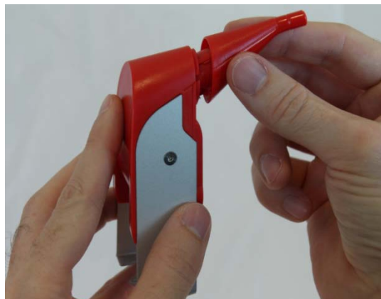
Abbildung 14: Aufstecken des Mundstücks
