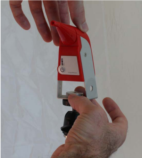
Abbildung 6: Montage der IntegraMouse Plus
