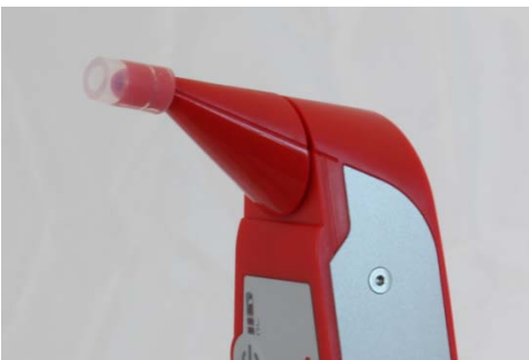
Abbildung 8: Korrekter Sitz des Silikonschlauchstücks.
